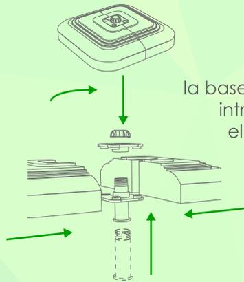
Una las dos mitades de la base y ajústelas introduciendo el eje con las dos tapas y ajuste.
