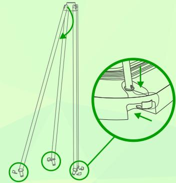
Desenvuelva las patas e introduzcalas en los agujeros de los extremos de la base y ajuste en la parte inferior
