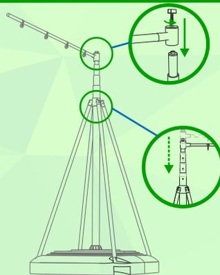
Deslice el vertical en las patas y ajuste el horizontal en el extremo superior de este.
