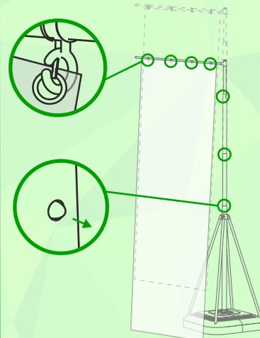
Instale la impresión en los aros del horizontal y deslice desplegando cada sección del vertical hasta que salga el tope.
