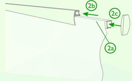
Adhiera la impresión al perfil interior y meta éste de nuevo en el horizontal. Coloque el tapón. Repita los pasos 1 y 2 con el horizontal inferior
