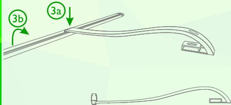
Inserte la pestaña de la base en el centro del horizontal inferior, luego gire éste hacia arriba 90° para ajustar.
