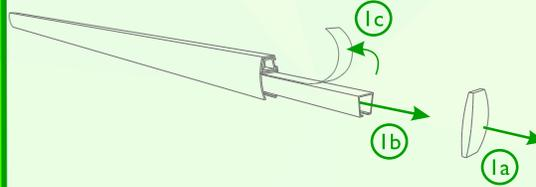
Retire el tapón de el horizontal superior, extraiga el perfil interior, retire el protector del adhesivo.
