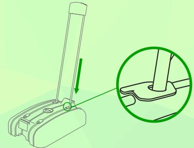
Asegure la estructura del tanque.
