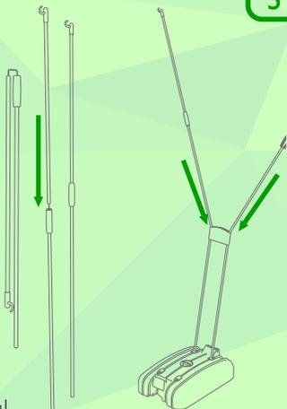
Ajuste los bastones superiores teniendo como resultado dos bastones largos, luego instalelos en la estructura central
